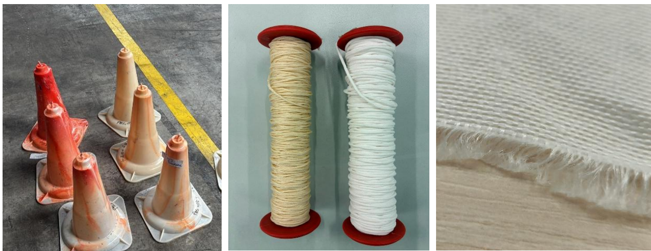
Ilustración 6: Piezas de inyección ,cuerdas y tejidos de trama y calada de PBAT y PBS
