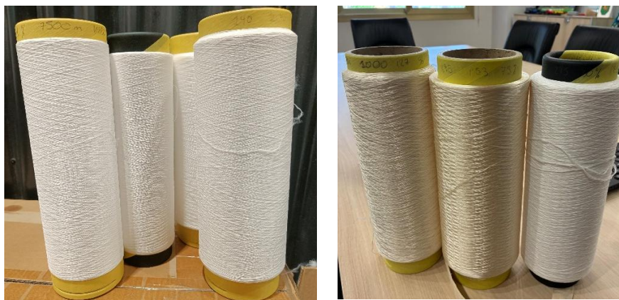
Ilustración 4: Muestras de hilos texturizados por DTY y ATY
