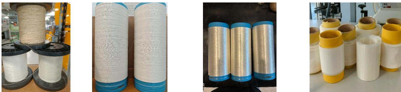
Ilustración 3: Muestras de hilaturas monofilamento, multifilamento y castfilm producidas en AITEX a partir de las formulaciones seleccionadas
