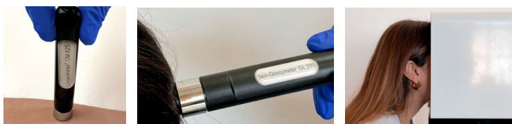
*Imágenes de izquierda a derecha: corneometer (hidratación), glossometer (brillo), cámara Visioface (arrugas)
