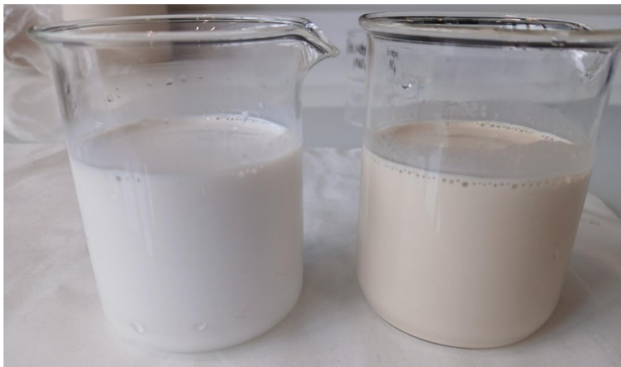
Dispersión de PU con biopoliol (izq) y con polioli reciclado (der)
