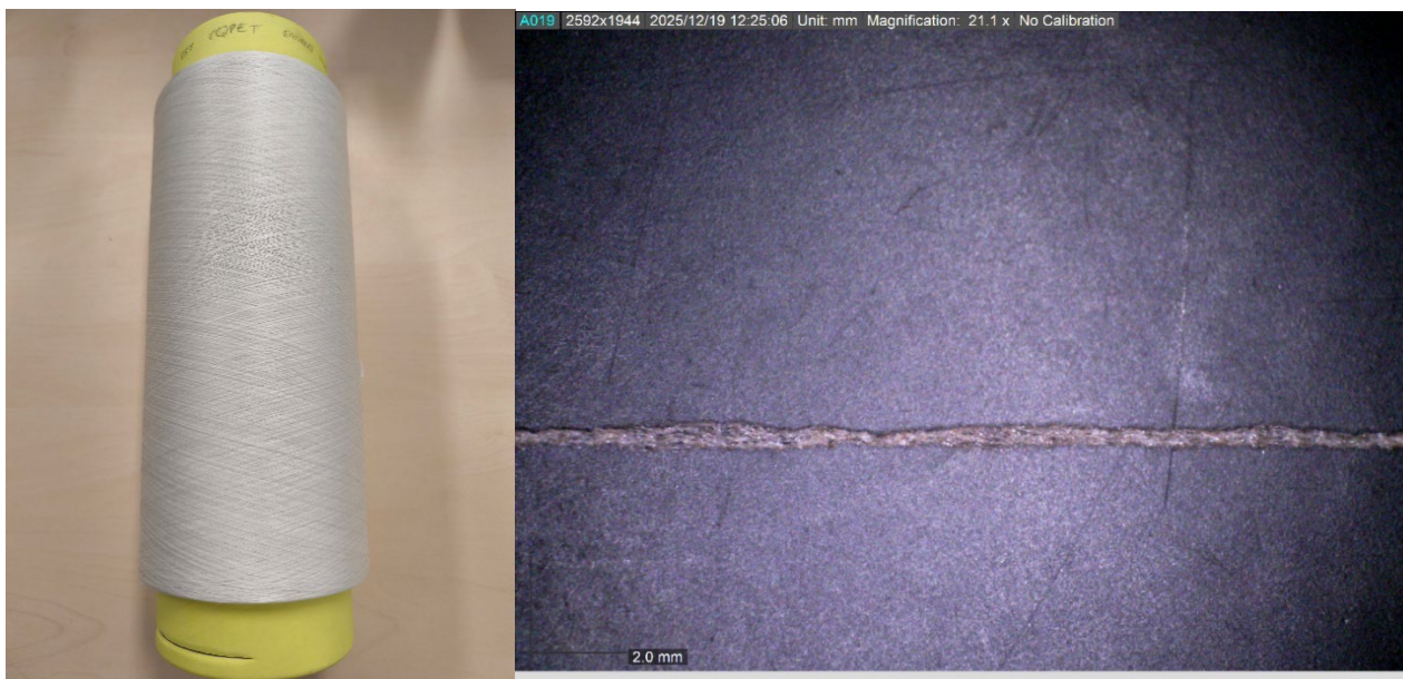
Bobina y detalle del hilo texturizado DTY de poliéster reciclado químicamente (rQPET) del proyecto ECOMELT 2025.
