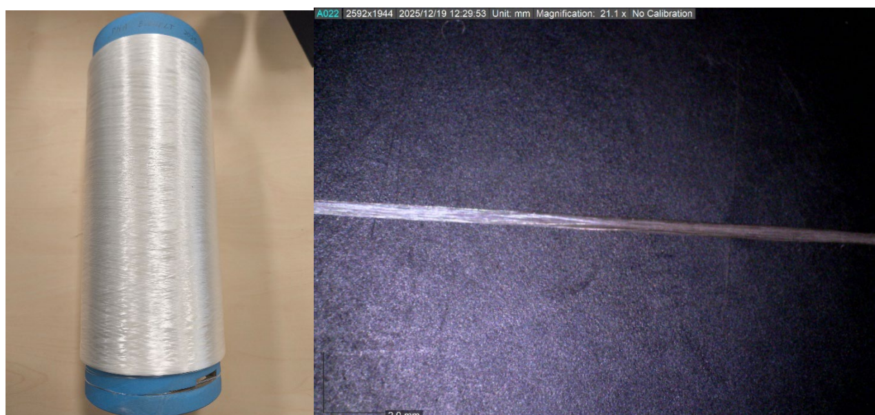
Bobina y detalle del hilo multifilamento de PHA del proyecto ECOMELT 2025.
