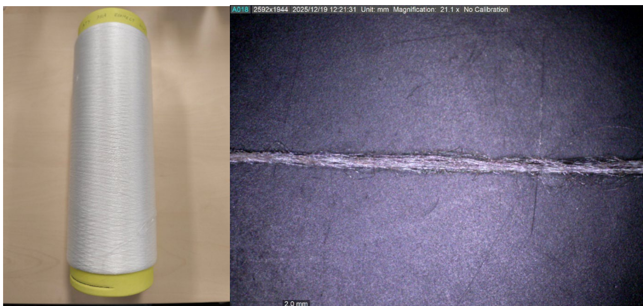
Bobina y detalle del hilo texturizado ATY de PHA del proyecto ECOMELT 2025.
