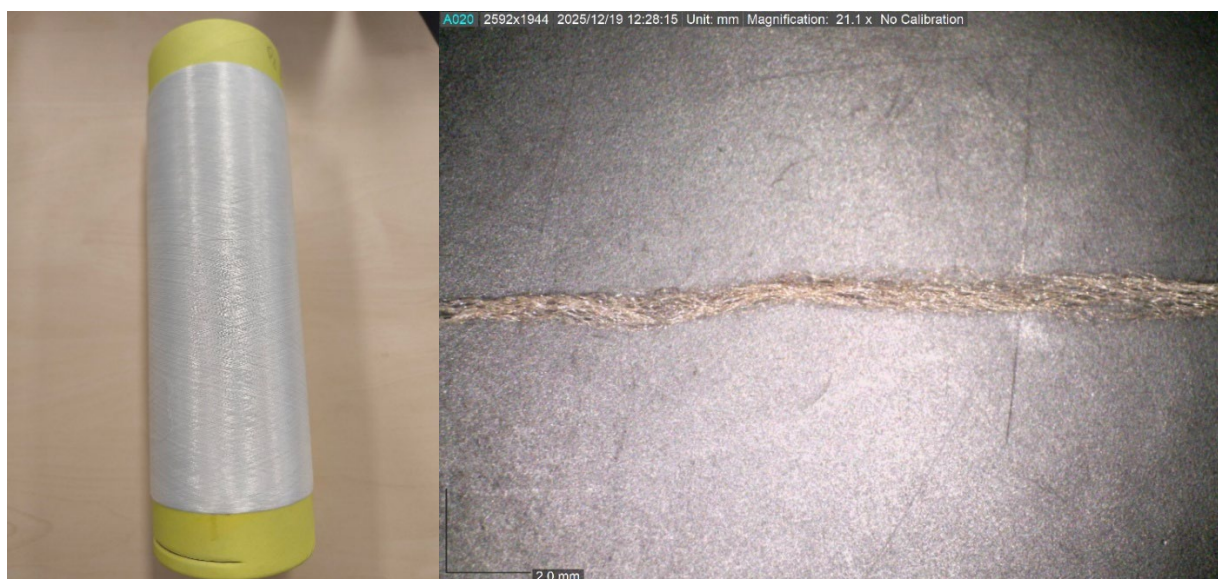
Bobina y detalle del hilo texturizado DTY de PHA del proyecto ECOMELT 2025.
