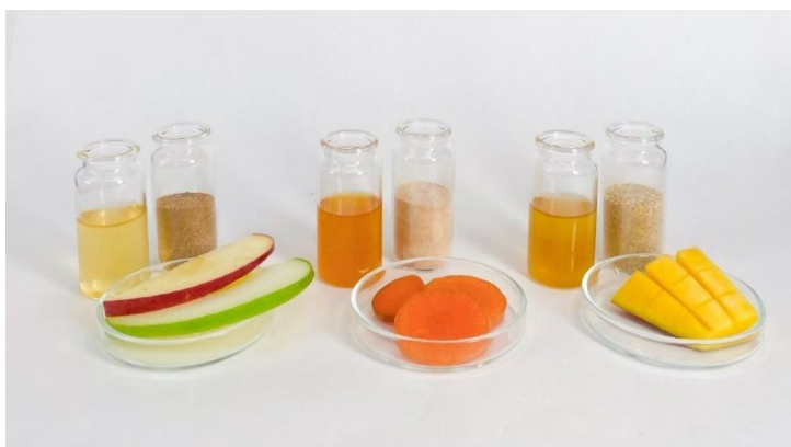
Ilustración 1. Extractos finales de manzana, zanahoria y mango obtenidos mediante extracción con NADES.
