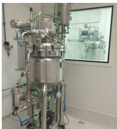
Il·lustració 6. Planta piloto. Reactor
