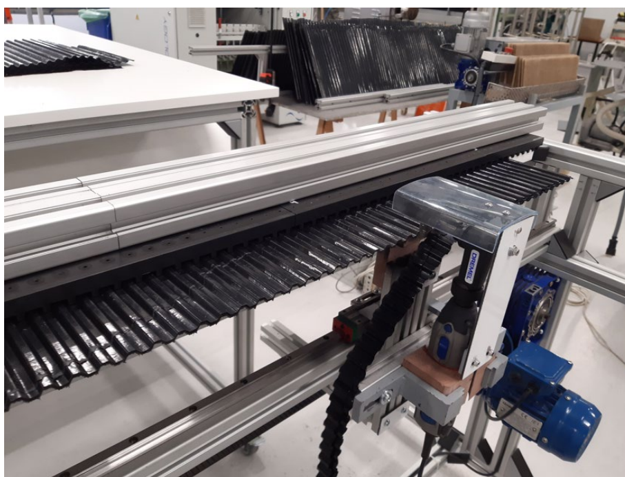
Corte de los corrugados a la medida correcta con el equipo automático montado.
