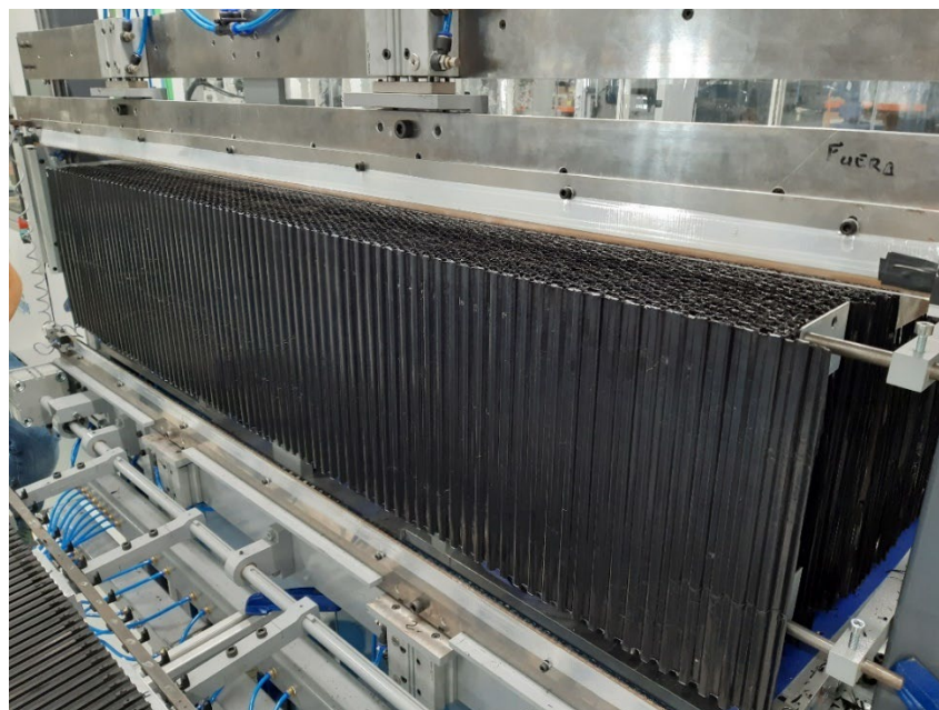
Disposición de las láminas corrugadas en el nuevo equipo de ensamblado
