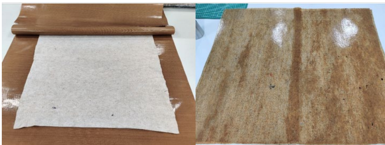
Proceso de laminación de liners exteriores para formación de paneles sándwich con núcleo HC de lino y PLA.
