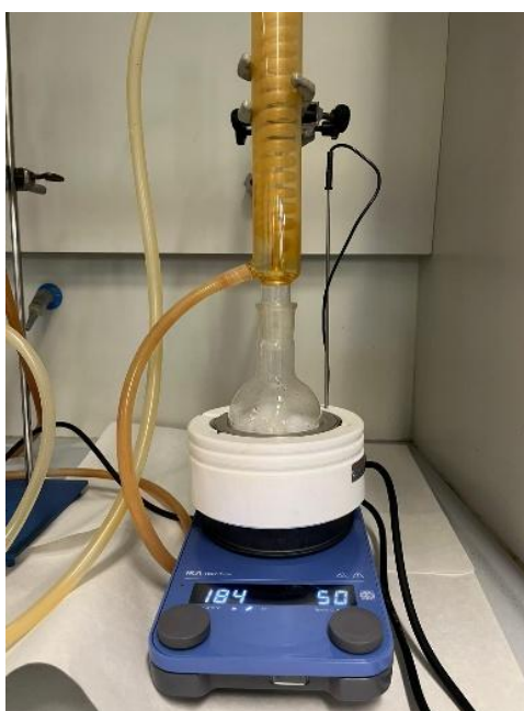
Figura 5. Montaje experimental para la reacción de despolimerización de poliamida 6.
