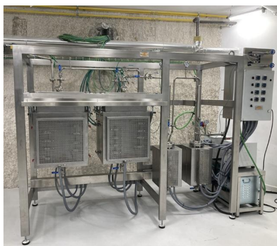
Figura 8. Planta piloto de pirólisis utilizada para el tratamiento termoquímico de materiales compuestos, con doble reactor y un tren de condensación
