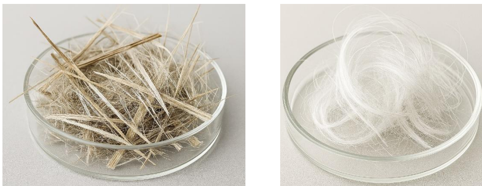
Figura 2. Fibras recuperadas tras solvólisis: comparación EP-IN (izquierda) y EP-PU (derecha).
