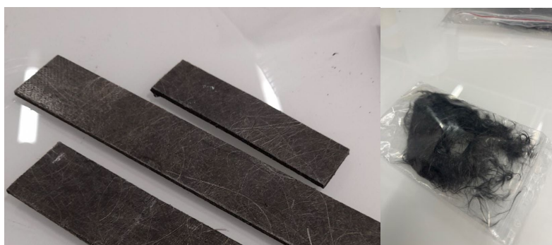
Ilustración 1. Residuo inicial de composite (izquierda) y fibras resultantes del proceso termoquímico (derecha).
