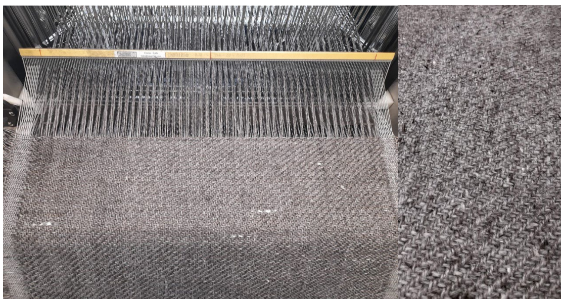
Ilustración 3. Tejido de calada situado sobre el telar (izquierda) y detalle del tejido sarga 2/2 (derecha). Direcciones de trama y urdimbre.
