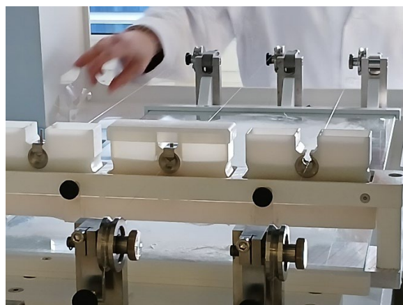
Figura 3. Vista del montaje de la configuración con 3 cables para simulación de producción industrial.
