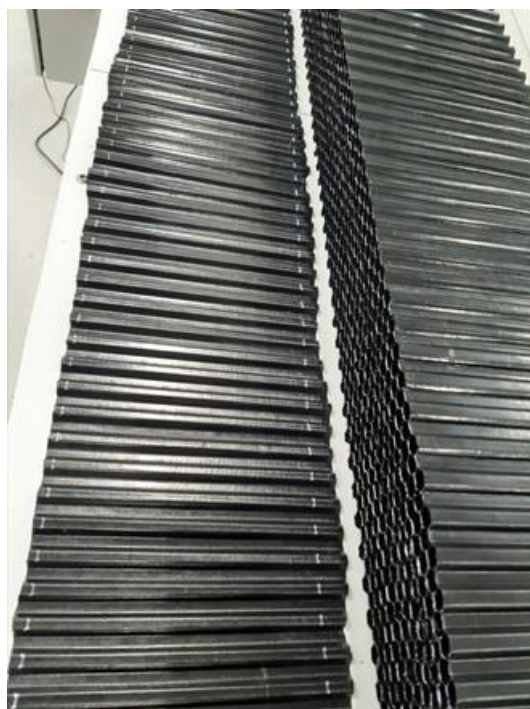
Corrugado obtenido a partir de la lámina fundida.
