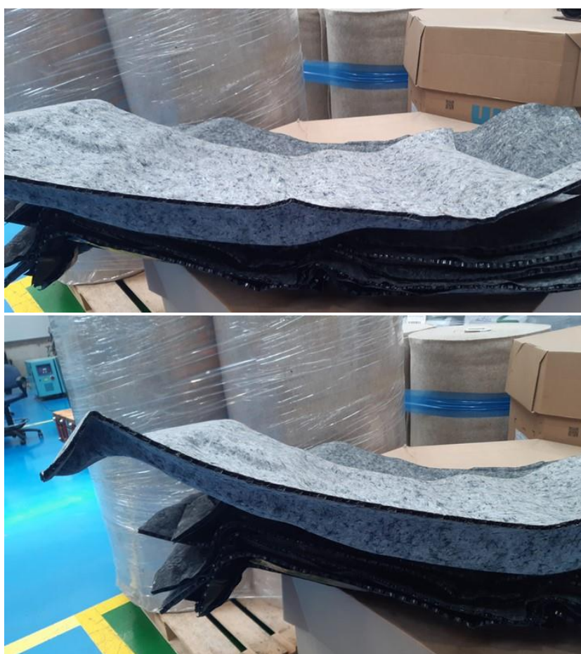
Conformado de los paneles sándwich con diferentes geometrías.
