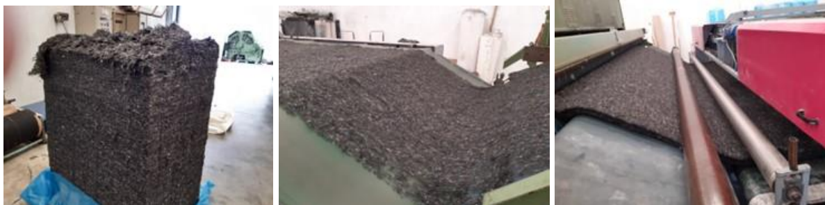
Formación de los no tejidos a partir de las fibras recicladas de poliéster.
