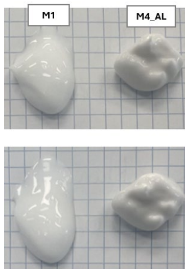
Ilustración 6. Mejora de la resistencia al deslizamiento de crema con celulosa marina (M4_AL) frente al control (M1).
