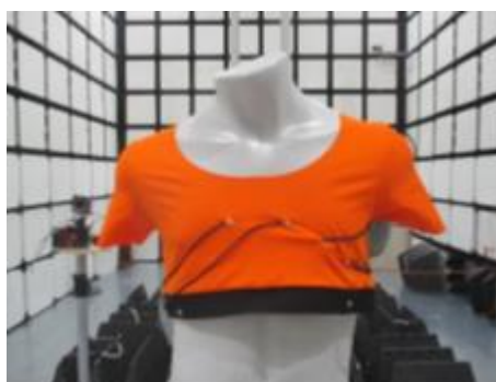
Figura 14. Prototipo realizado para pruebas del cableado apantallado.
