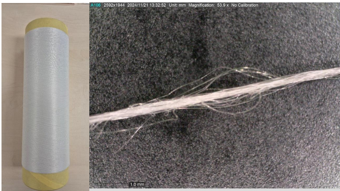
Bobina y detalle del hilo texturizado ATY de poliéster reciclado químicamente (rQPET) del proyecto ECOMELT 2024.
