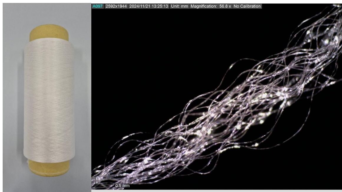
Bobina y detalle del hilo texturizado DTY de poliamida de origen BIO (BioPA) del proyecto ECOMELT 2024.
