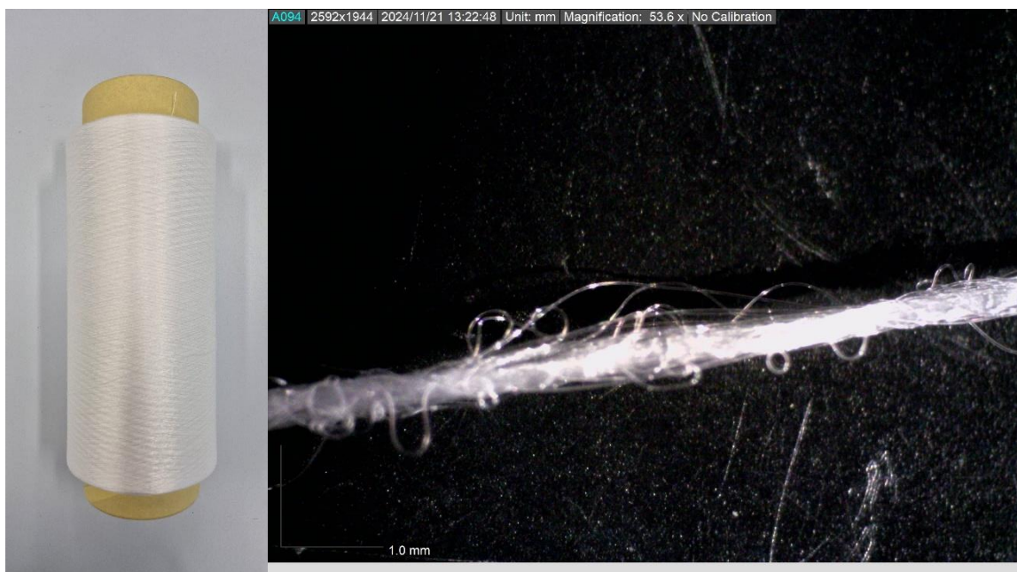
Bobina y detalle del hilo texturizado ATY de poliamida de origen BIO (BioPA) del proyecto ECOMELT 2024.
