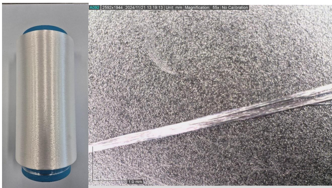
Bobina y detalle del hilo multifilamento de poliamida de origen BIO (BioPA) del proyecto ECOMELT 2024.
