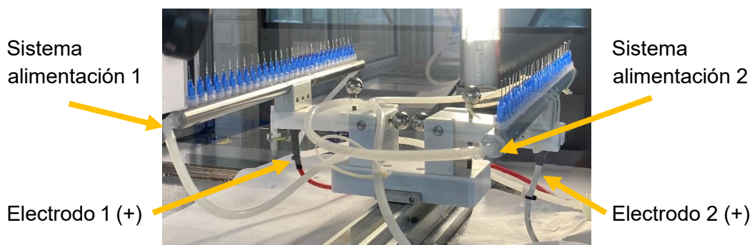
Figura 14. Esquema de componentes de suministro de disolución polimérica y de corriente eléctrica, a las 2 hileras de agujas (60 agujas en total).
