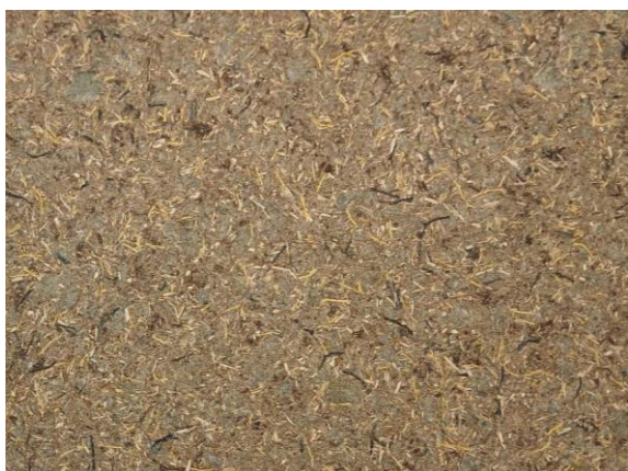
GLB-WD-ARA-12 Material desarrollado con un 48% de residuo textil de aramida.
