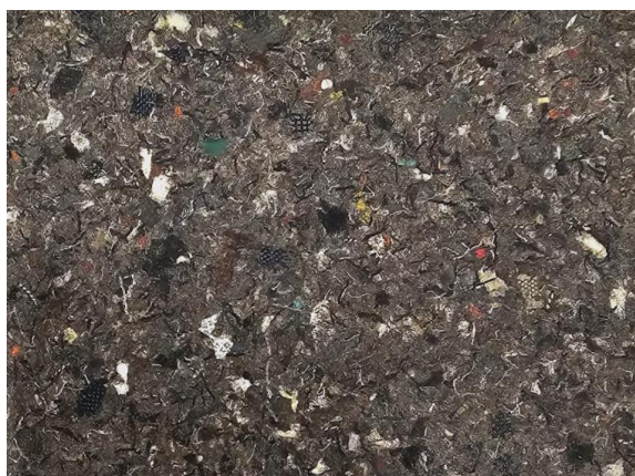
GLB-WD-01-WO-10-02 Material desarrollado con un 90% de residuo textil de lana.
