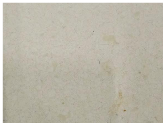
GLB-WD-04-PESFR-BLN-10-02 Material desarrollado con un 90% de residuo textil de poliéster.
