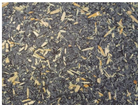
GLB-WD-DNM-10-08 Material desarrollado con un 56% de residuo textil de denim y 24% de fibras de madera.
