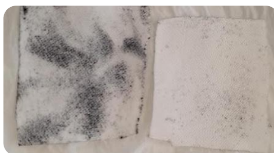
Figura 14. Efecto anti-redeposición. Izquierda Referencia. Derecha detergente aditivado con biopolímero.
