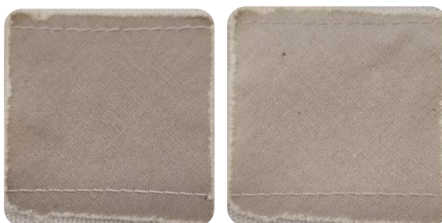
Figura 7. Mancha enzimática (salad dressing): izq) referencia y dcha) detergente aditivado con enzimas
