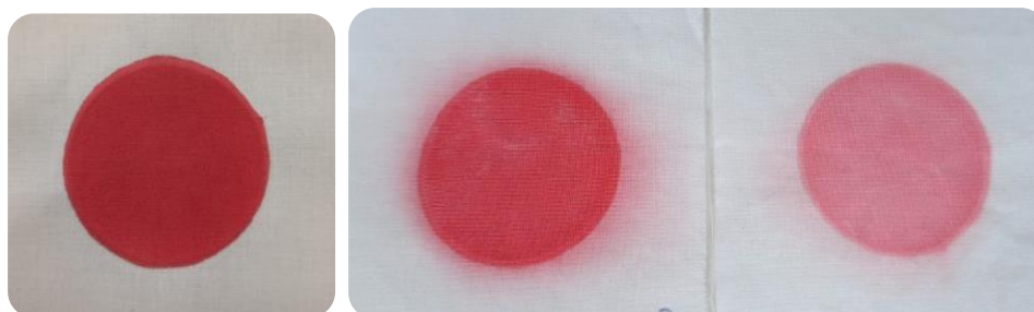
Figura 10. Comparativa de los tejidos basic cotton con suciedad CFT: (izq) tejido inicial sin lavar, (centro) tejido lavado con ref y (dcha) tejido lavado con detergente aditivado con fosfodiesterasa.
