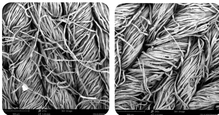
Figura 13. Imágenes de SEM. Izq) estado inicial. Dcha) tras los 20 lavados con celulasa
