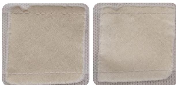
Figura 6. Mancha enzimática (césped): izq) referencia (dcha) detergente aditivado con enzimas
