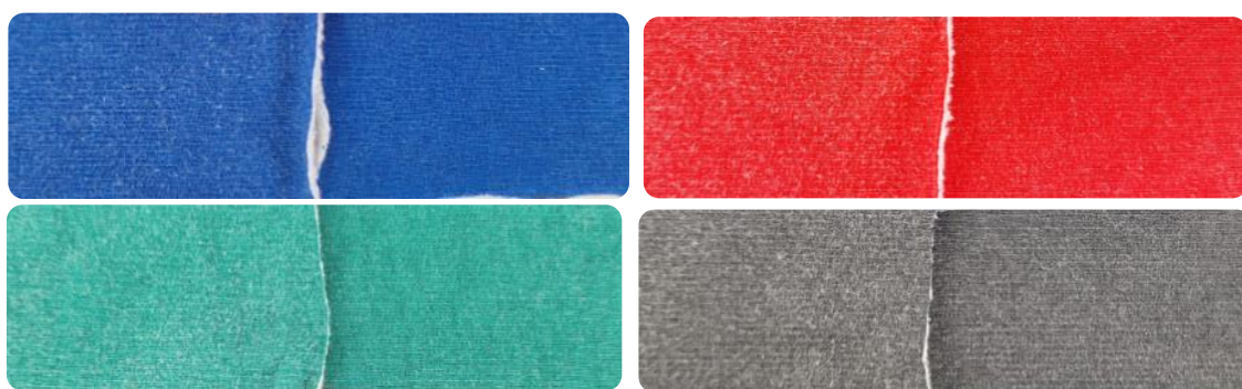
Figura 12. Detalle franjas de color monitos E-253. Izq) sin lavar y dcha tras 20 lavadas con celulasa.
