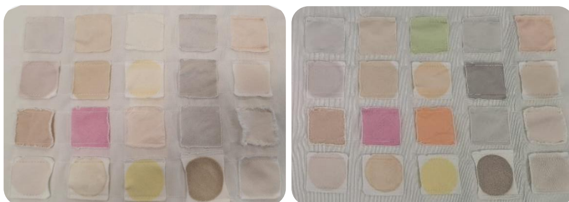
Figura 9. Monitor AISE A+B plus tras lavado. Izquierda) prototipo DF_DR_4enz y derecha) detergente ECO comercial
