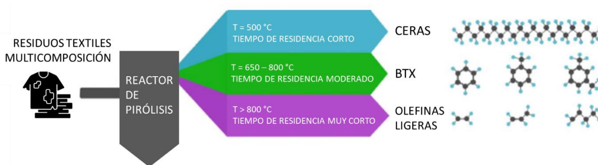
Figura 10. Diagrama de las corrientes de entrada y salida del proceso de pirólisis
