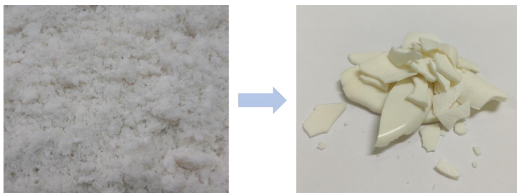
Figura 6. BHET (izquierda) y PET obtenido tras la polimerización (derecha).
