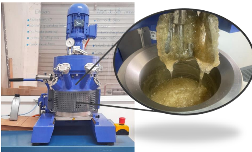
Figura 8. Preparación del "dope" a escala piloto.
