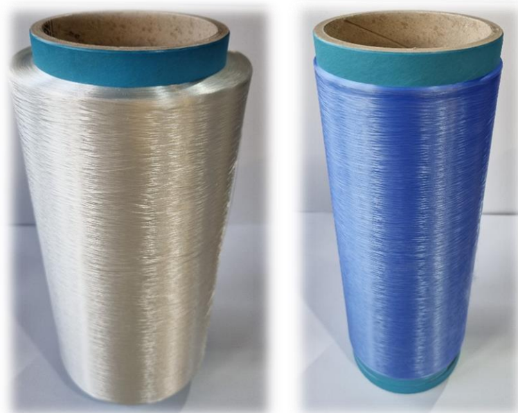
Figura 4. Izquierda: Hilo multifilamento de PLA desarrollado en el proyecto PLABITEX II; Derecha: Hilo multifilamento de PLA tintado en masa desarrollado en el proyecto PLABITEX II.
