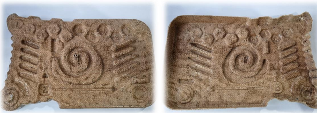
Figura 16. Biocomposite demostrador compuesto de PLA y YUTE desarrollado por AITEX en el proyecto PLABITEX II.
