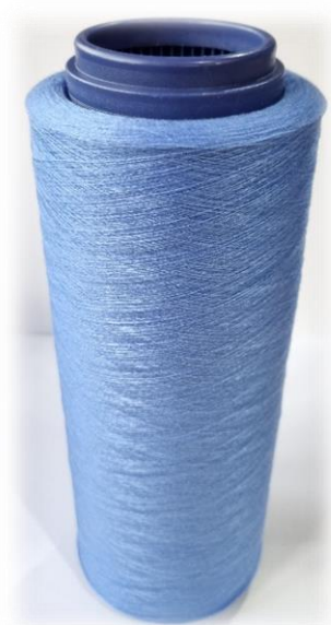
Figura 5. Hilo multifilamento de PLA tintado por AUTOCLAVE desarrollado en el proyecto PLABITEX II.
