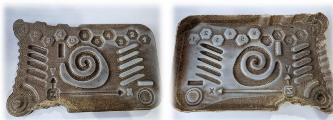
Figura 15. Biocomposite demostrador compuesto de PLA y LINO desarrollado por AITEX en el proyecto PLABITEX II.
