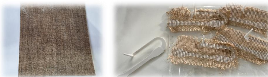
Figura 8. Izquierda: Biocomposite de PLA/LINO obtenido por termo-conformado en el proyecto PLABITEX II; Derecha: Probetas de PLA/YUTE obtenidas por inyección sobre sustratos textiles en el proyecto PLABITEX II.
