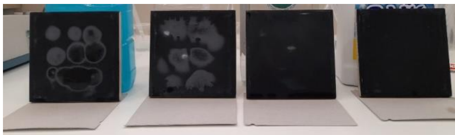
Figura 24. Resultados eliminación de cal. Desde izq: WC_2, WC_1 y limpiadores comerciales CRF y CHB
