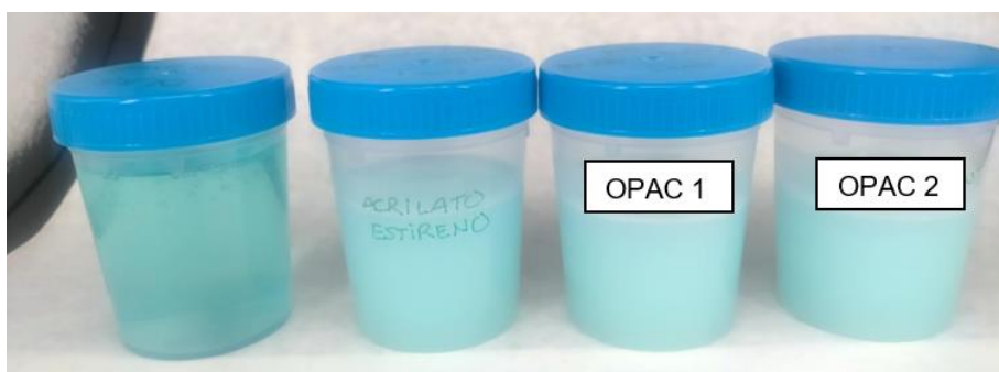
Figura 19. Desde izquierda: detergente inicial, det. con opacificante acrilato/estireno y detergentes con opacificantes libres de microplásticos
