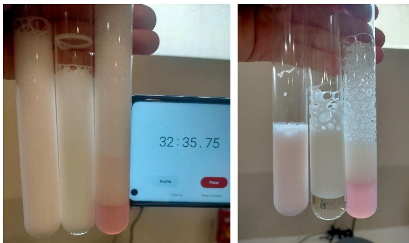
Figura 28. Estado de las emulsiones a los 30 minutos desde agitación y al día siguiente
