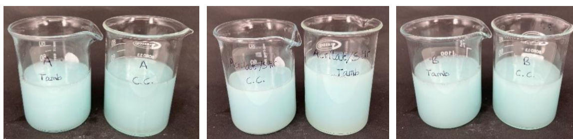
Figura 41. Comparativa de cada una de las muestras T ambiente vs. C.C. (Izq) A, centro) Acrilato/estireno y dcha) B.
