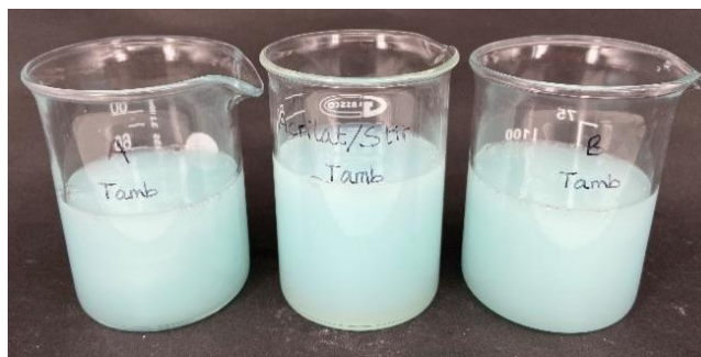
Figura 39. Muestras a T amb. Desde izq: opacificante A, Acrilato/estireno y opacificante B
