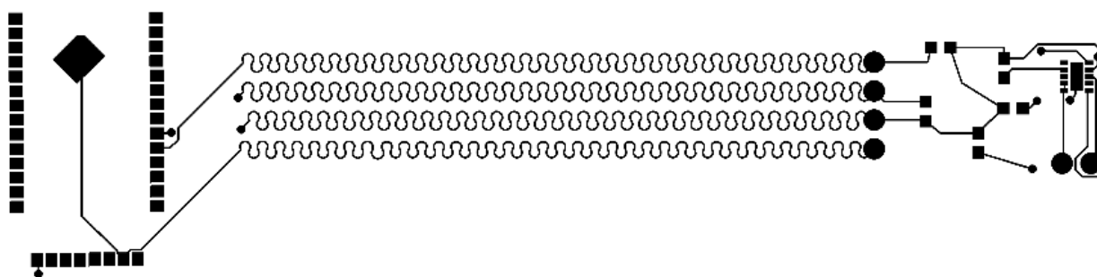
Figura 7. Diseño circuito estirable para fabricación en poliuretano.
