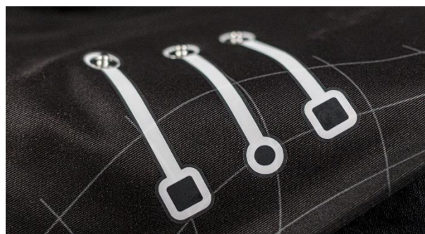
Figura 4. Electrodos impresos sobre sustrato textil.
