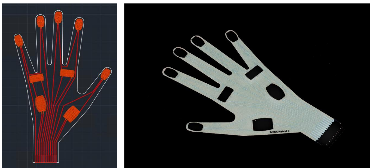
Figura 5. Diseño guante táctil con sensores de fuerza.
