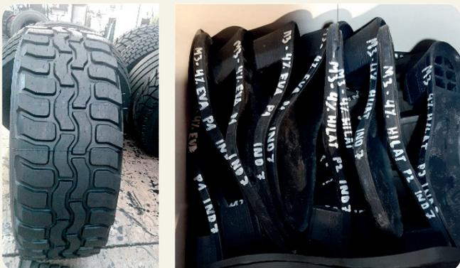
Figuras 1 y 2. Prototipo de neumático agrícola fabricado con una de las formulaciones desarrolladas y prototipos de suelas para calzado elaborados con diferentes formulaciones desarrolladas.
