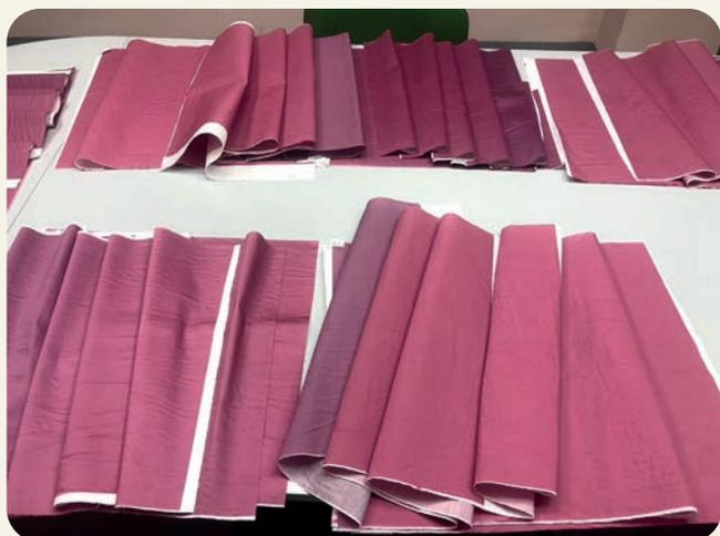
Figura 4. Diferente comportamiento del colorante logwood en medio ácido o básico (arriba); gama de tejidos con diferentes preparaciones y estampados digitalmente, con tinta formulada en base a colorante natural, y sólidos al lavado doméstico (abajo).
