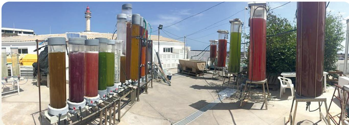
Figura 3. Cultivo de microalgas en bioreactores en las instalaciones del Banco Español de Algas (BEA).
