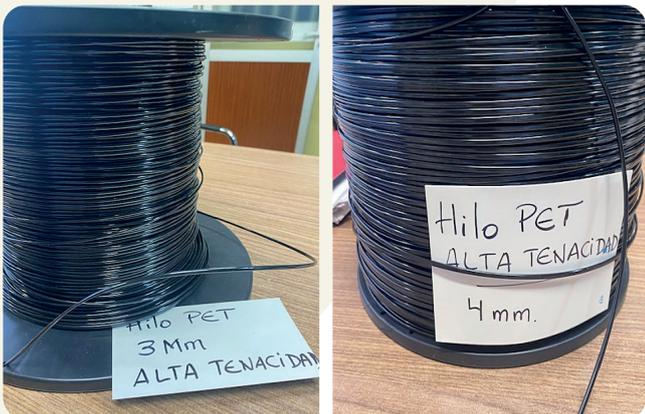
Figuras 3 y 4. Monofilamento de PET HT 3mm y 4mm.
