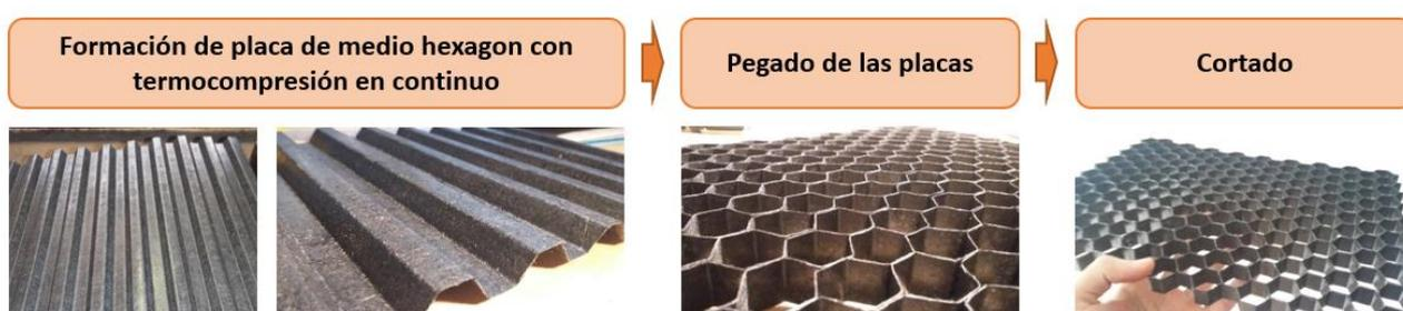
*Esquema del proceso seguido para la obtención de la nueva generación de honeycombs desarrollados en el proyecto.*
