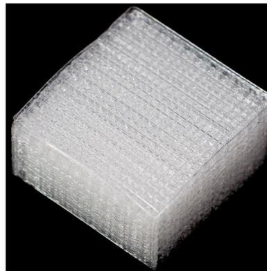
Figura 24. Scaffold obtenido mediante impresión de PLA y deposición lineal de hidrogel
