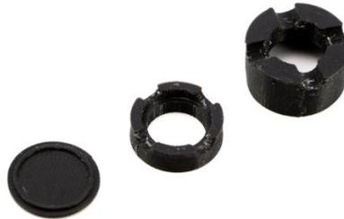
Figura 21. Detalle de los 3 componenetes (base + tapa + core) tras su impresión 3D.
