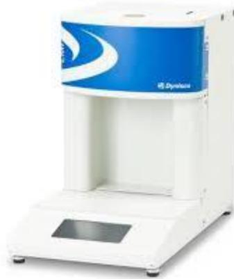
El test de fluidez se ha llevado a cabo a una temperatura de 230°C y un peso de 2,16 Kg, siguiendo las condiciones que se indican en la norma EN ISO 1133. La norma aplicada en este estudio de caracterización es la que se centra en el estudio del índice de fluidez del polipropileno, ya que el material en estudio consta mayoritariamente de dicho polímero.
