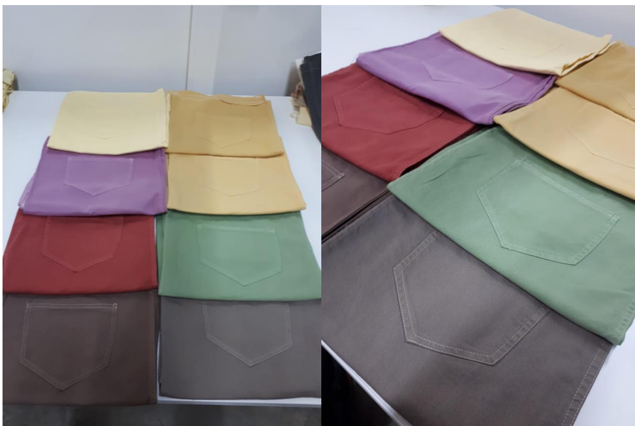
2 - Prendas de algodón/elastano teñida con colorantes naturales mediante formulaciones de baja temperatura
