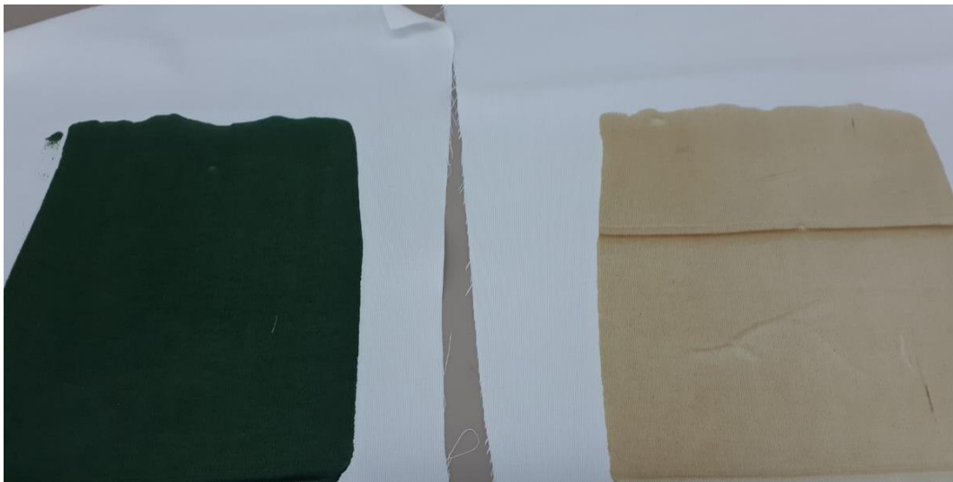
6- Recubrimiento con clorofila (izquierda) y Punica granatum (derecha), empleando ligante parcialmente basado en polisacáridos.
