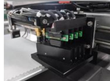
El principio de funcionamiento es sencillo: Un electroimán activa un émbolo que abre y cierra una boquilla.
