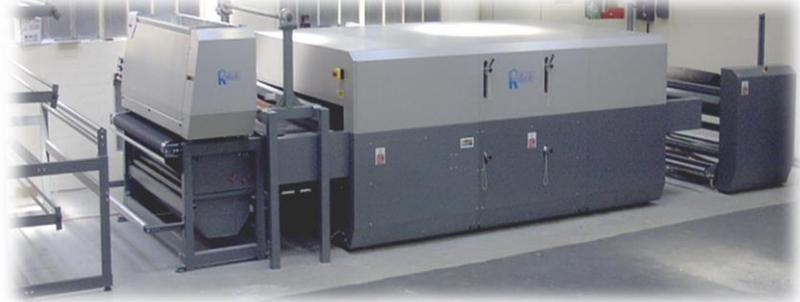
AITEX, dispone del proceso de laminado, compresión y fusión continua mediante la tecnología RELIANT con el objetivo de poder laminar varias capas utilizando adhesivos termoplásticos en diferentes formatos, como puede ser el polvo a través de una unidad de dispersión y mediante films, webs o mallas a través de bobinas.
