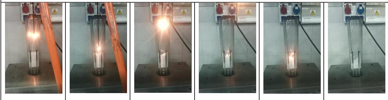
Secuencia de quemado de la probeta de no tejido 92% PES + 8% aditivo FR. La llama se propaga inicialmente pero antes de llegar a la mitad de la probeta se apaga por el efecto del aditivo FR.
