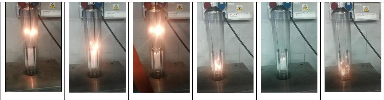
Secuencia de quemado de la probeta de no tejido 100% PES. La llama se propaga hasta que se quema la probeta completa
