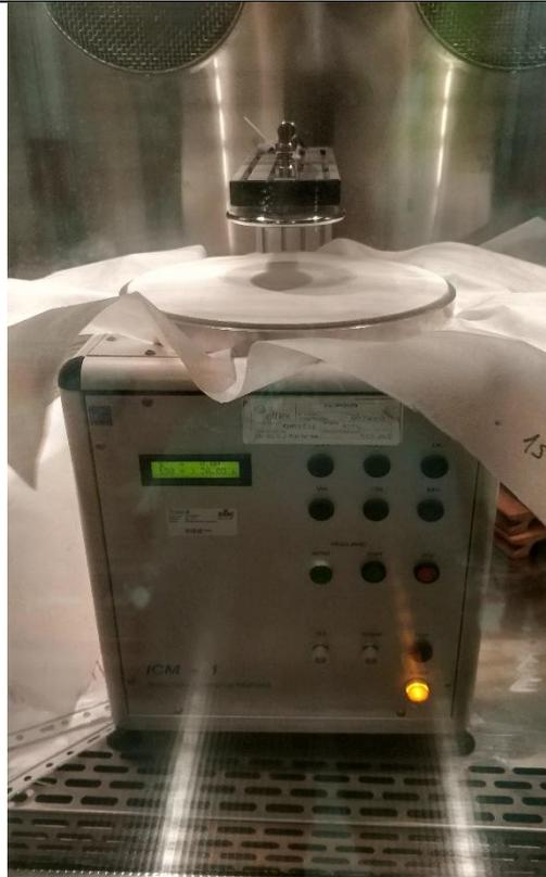
Ensayo de disipación eléctrica y resistividad superficial sobre las muestras de no tejidos de PLA aditivados.
