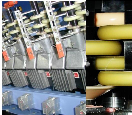
Figura 5 Ejemplos de unidades de discos apilados
