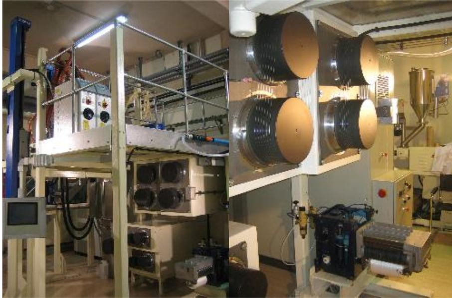
Figura 6 Planta piloto de extrusión multifilamento
