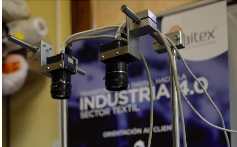
Figura 14 Prueba de visión artificial para la detección de defectos en tejidos de decoración
