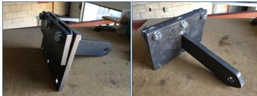
Figura 5 Soportes de anclaje de los cables de acero
