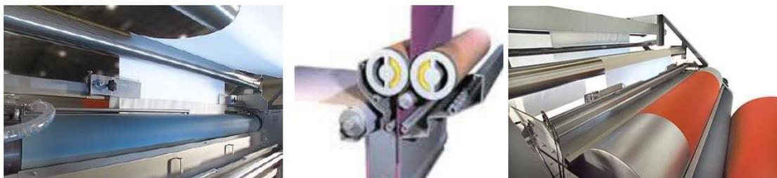
**MONFORTS.** Un sistema basado en proceso Termosol que es capaz de modificar su distancia entre los cilindros de exprimido, para evitar arrugas, dobleces y que además es capaz de procesar sin problemas tejidos con lycra. Además, la impregnación puede ser controlada automáticamente.
