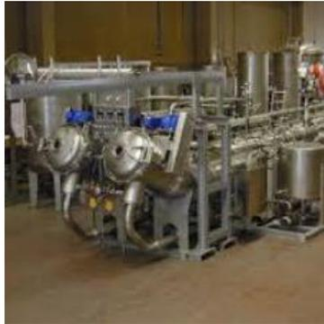
**ALLIANCE TEXTILES - ROTORA.** Máquina de tintura por autoclave con una distribución optimizada del baño de tintura dentro de la cámara.
