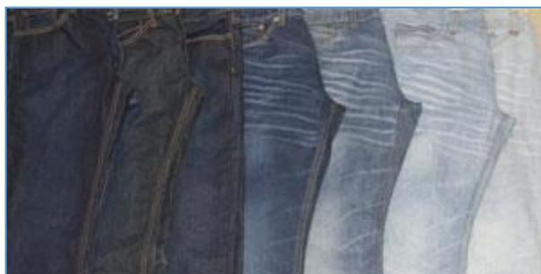
***Rango de efecto de bleaching (blanqueo) obtenido sobre denim mediante ozono (Fuente: Ozone Finishing for Denim Reduces Environmental Impact, Processing Costs and Processing Time. Apparel, Enero 2014).***
