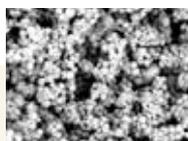
Observación microscópica de microcápsulas de orégano obtenidas mediante polimerización interfacial
