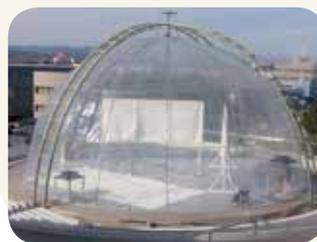
Imagen 1. Instalación de los tejidos en la cámara EUPHORE.
