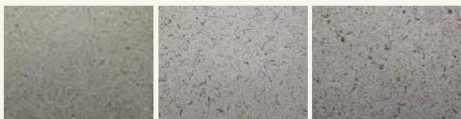
Imagen 6. Materiales compuestos fabricados mediante termocompresión a partir de los no tejidos wet-laid.
