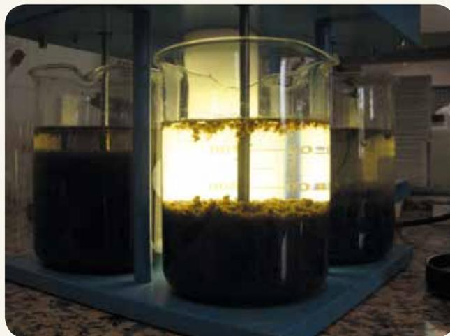
Imagen 1. Proceso de coagulación-floculación con productos ADNATUR mediante JAR TEST.
