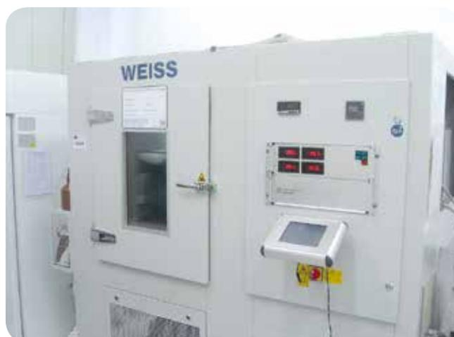
Imagen 1. Equipo Skin Model de AITEX para la determinación del Índice de Permeabilidad al vapor de agua
