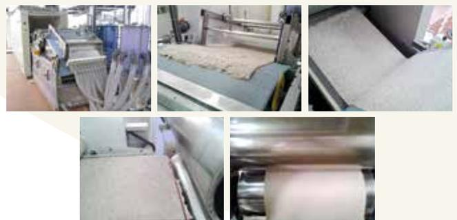
Imagen 2. Proceso de fabricación de un no tejido de lino mediante tecnología wet-laid.
