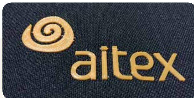
Imagen 2. Detalle de las estructuras tridimensionales impresas sobre sustratos textiles.
