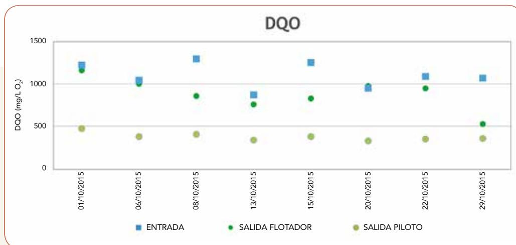
Figura 1. Se observan reducciones de la DQO con el tratamiento convencional, de entre el 4-50%, mientras que con el pilotaje ADNATUR se obtienen reducciones de la DQO mucho más regulares, rondando todas ellas sobre el 65%. (Nota: La "ENTRADA" se corresponde con las aguas provenientes de la unidad de decantación).
