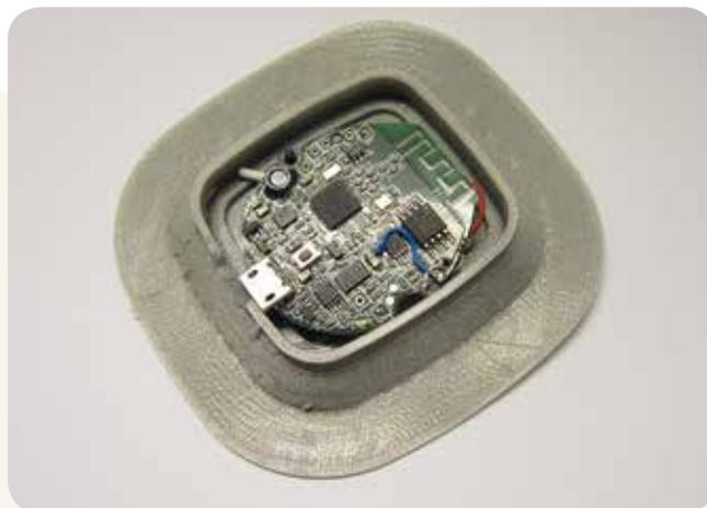
Imagen 2. Encapsulado para electrónica realizado por impresión aditiva.
