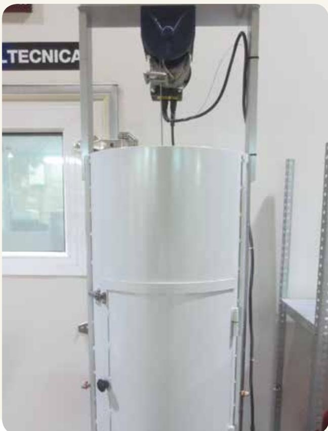
Imagen 3. Equipo para realizar el ensayo "filling power".
