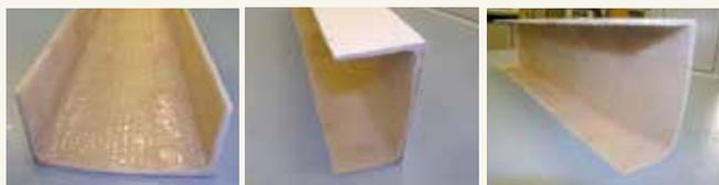
Imagen 5. Perfil en U de material compuesto con resina termoestable.
