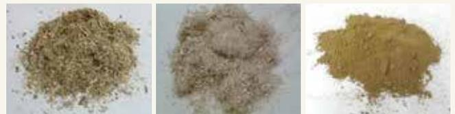
Imagen 1. Tipología de residuos utilizados en la tecnología wet-laid. De izquierda a derecha: residuo de palmera; residuo de lino; residuo de orujo.
