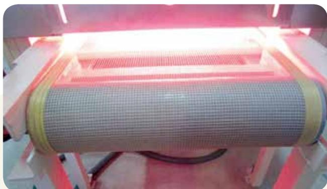
Imagen 1. Sistema de pulverizado y secado en las instalaciones de la empresa.
