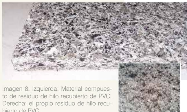
Imagen 8. Izquierda: Material compuesto de residuo de hilo recubierto de PVC. Derecha: el propio residuo de hilo recubierto de PVC.
