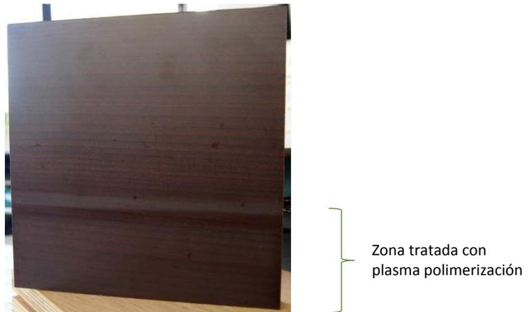
Figura 2.- Muestra tratada con plasma polimerización para aumentar la hidrofobicidad.
