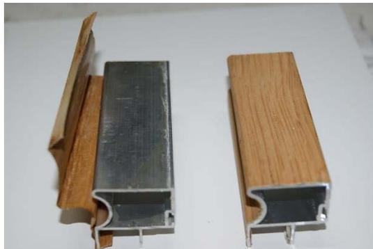
Figura 4.- Muestras de piezas de aluminio revestidas de chapa de madera. En la muestra de la izquierda se observa el despegue por falta de adherencia de ambos materiales.
