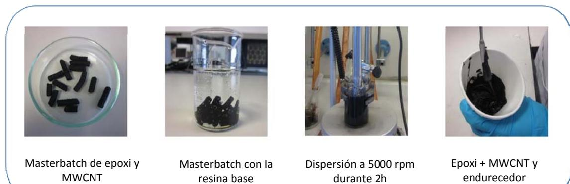
Fig.1. Proceso de dispersión de cargas nanoconductores en “gel-coat”.
