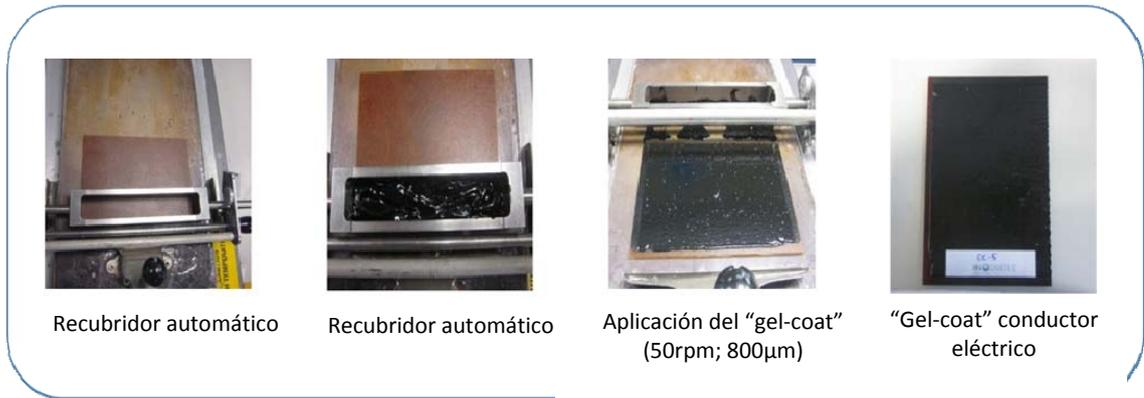
Fig.2. Aplicación del “gel-coat” al sustrato composite.
