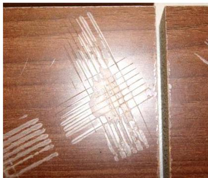
Figura 3.- Ejemplo del déficit en adherencia entre un tablero con acabado de melamina y barniz.
