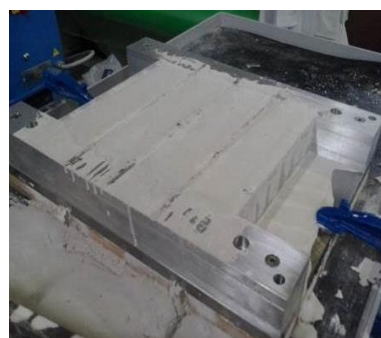
Molde con el composite de escayola y fibra en proceso de secado
