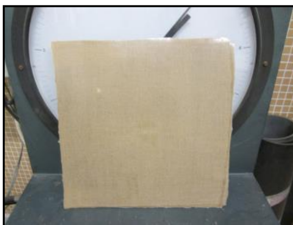
Muestra del composite ignífugo desarrollado mediante infusión de resina.
