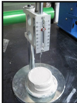
Mezclado de la mezcla en amasadora y medición del inicio del fraguado mediante el ensayo del cono de Vicat.
