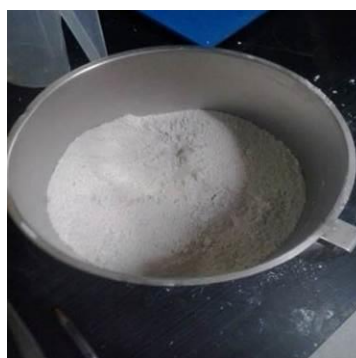
Colocación de los componentes del composite en la tolva de mezclado.
