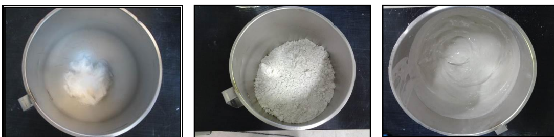
Colocación de los componentes del composite en la tolva de mezclado y mezclado manual
