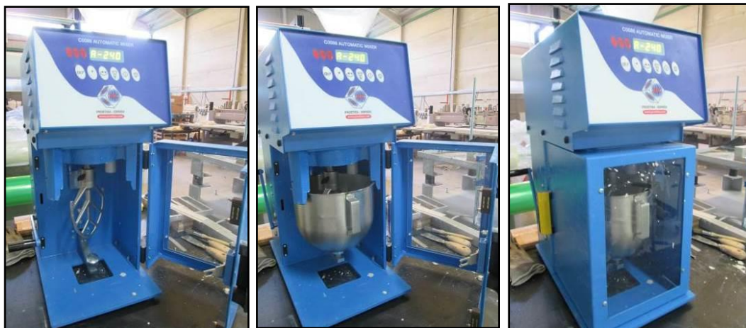
Introducción de la tolva en el interior de la amasadora.
