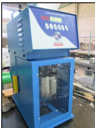
Mezclado de la mezcla en amasadora y medición del inicio del fraguado mediante el ensayo del cono de Vicat.
